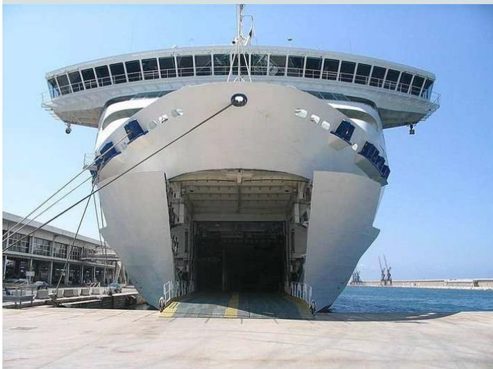
**Portellone di prua su nave ro-ro** (da *MacorMarine*). Qui gli automezzi possono imbarcarsi e poi sbarcare direttamente, senza bisogno neanche di fare retromarcia, ma si tratta di navi di piccola stazza adibite a collegamenti secondari (in Italia, in genere, tra terraferma e isole minori).
